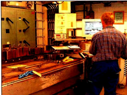
Test van breeksterkte en totale rek van de ketting
